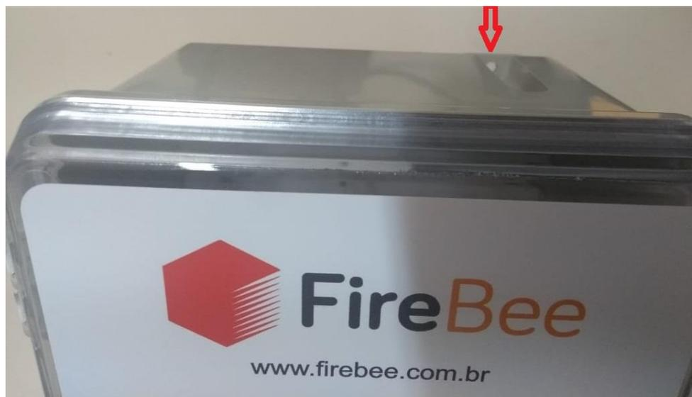
Figura 10 - Furo auxiliar superior.
