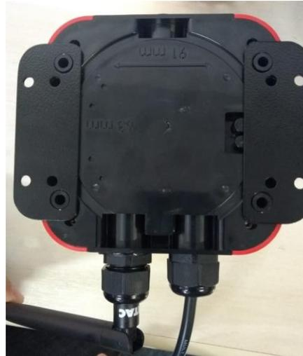
Figura 13 - Placas de fixação na caixa GFE.
